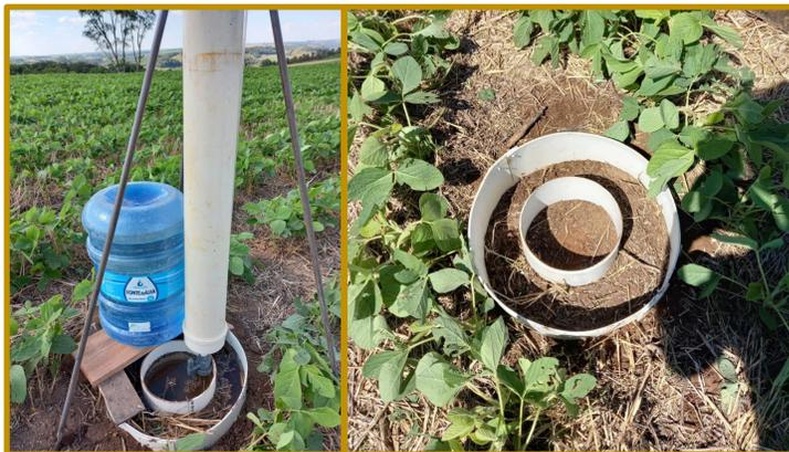
Figura 1. Infiltrômetro de anéis concêntrico.
